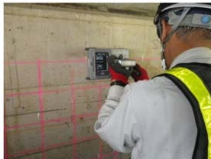
写真 4-4 鉄筋探査状況
