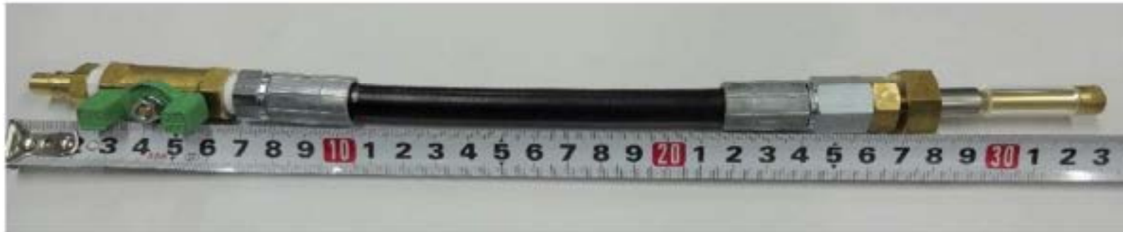
写真2-2 加圧パッカー（パッカー径φ10mm）
