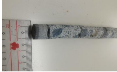
粗骨材を除くことで精度向上
