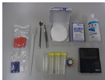
簡易塩化物イオン濃度測定器
