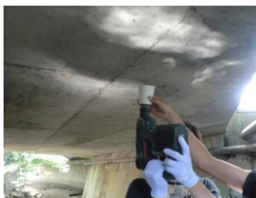
コンクリート粉末の採取状況 具
